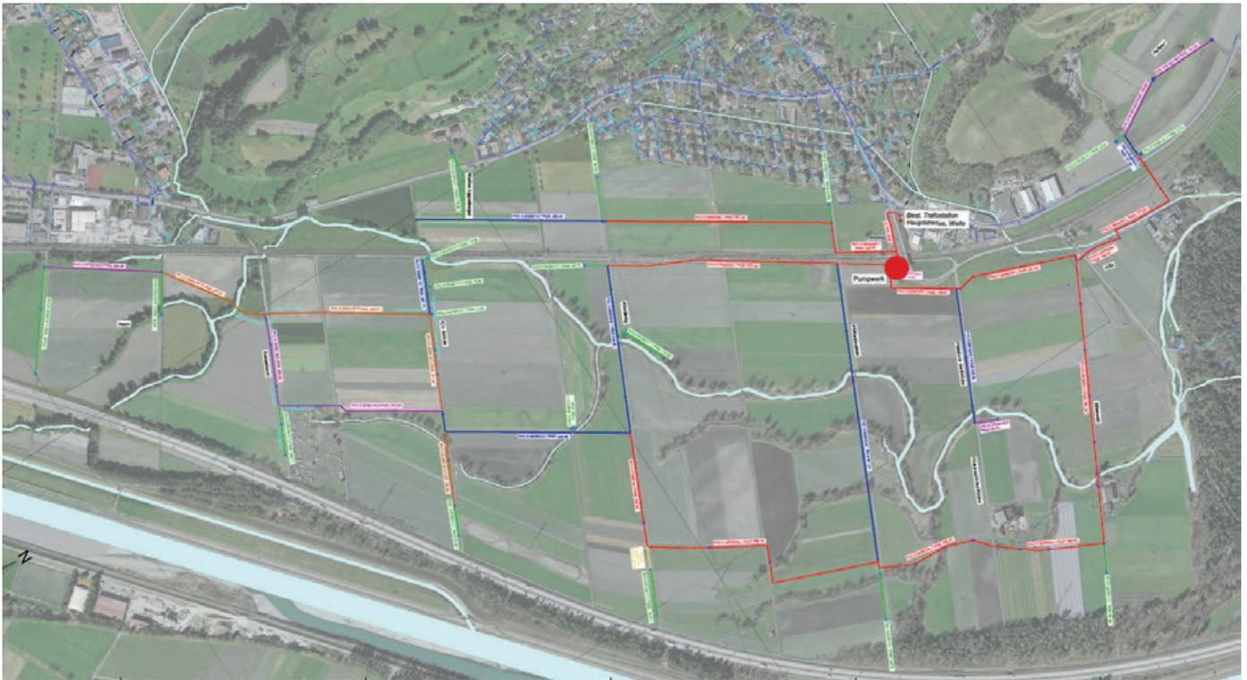
Leitungsnetz Bewässerung Wartau Süd mit Grundwasser-Pumpwerk (roter Punkt)
